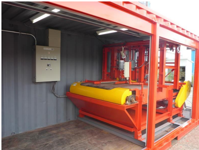
移動式切削機 20ft コンテナに設置
